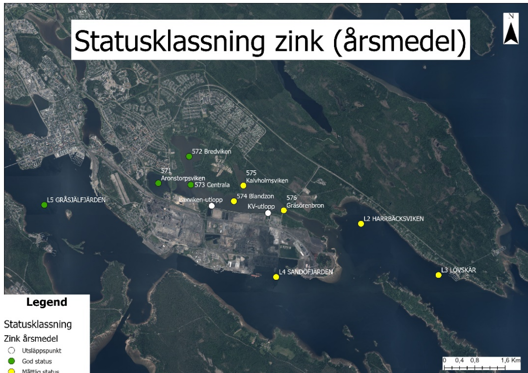
Figur 1. Statusklassning för zink i Inre Hertsöfjärden, Sörbrändöfjärden och Sandöfjärden, baserat på bolagets vattenkemidata från egenkontrollen. Grön färg motsvarar god ekologisk status och gul färg motsvarar måttlig ekologisk status. Miljökvalitetsnormerna för samtliga vattenförekomster är god ekologisk status 2027 vad gäller zink. Det finns därmed ett åtgärdsbehov kopplat till bolagets verksamhet för att normerna ska kunna följas 2027.
